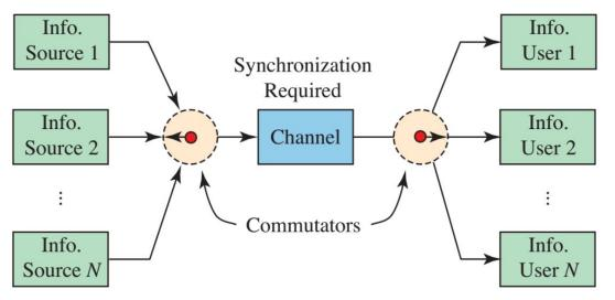
For equal bandwidth sources : *s*1 *s*2 *s*3 *s*2 *s*3 *s*1 *s*2 *s*3 *s*1 *s*2
